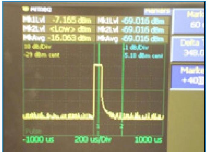
(d) Measuring sub-pulses within a signal burst
